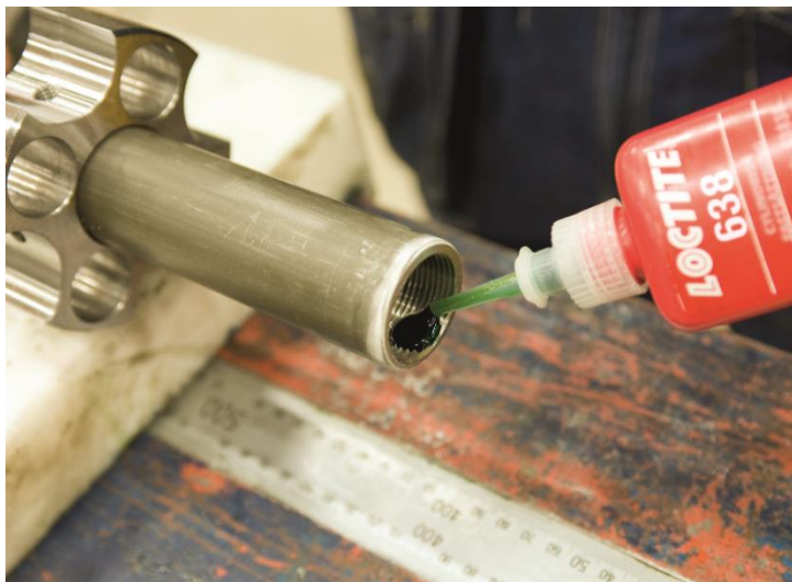
ロックタイト638でねじにゆるみ止めとシーリングを施す
