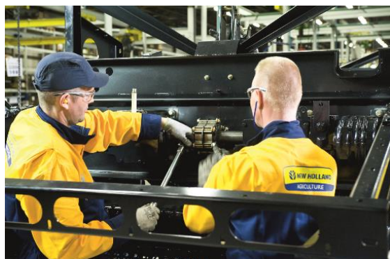
スレッシュャーのメインギヤのボルトは、信頼性を最大限に高めるため固く締め付けられる
