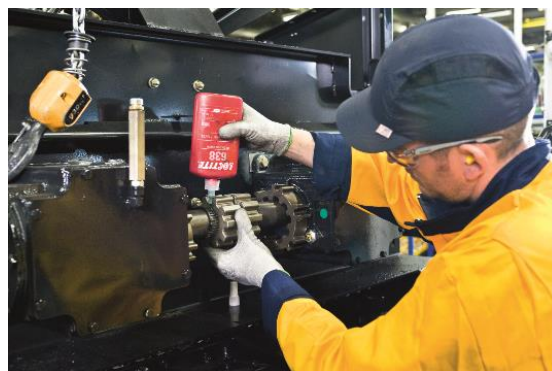
使用シャフトのハブ・ジョイントの組み立てにははめ合い用接着剤ロックタイト 638
