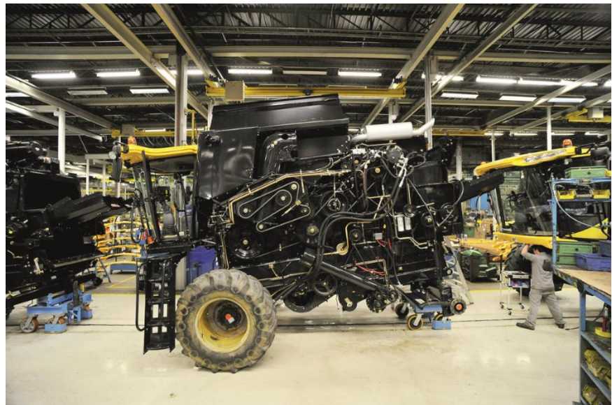
収穫機の手輪の組み立てが完了し、次の製造段階に進む準備が整った
