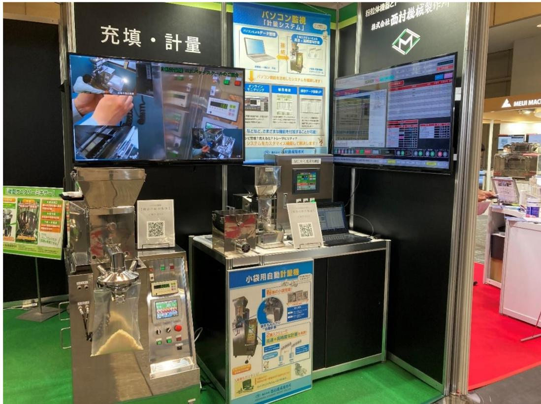
小分け用自動計量充填機です。このタイプでは50g～1500gの原料を袋へ自動計量充填を行います。スタート時に大スクリーン+小スクリーンによる大量供給→秤量値の直前で小スクリーンのみで微調整を行うことで短時間且つ高精度な計量を行います。
