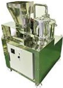
空気の高速度渦流による気流粉碎機です。超高速気流に揉まれ、原料同士が適度な衝突を繰り返す自己粉碎方式です。
