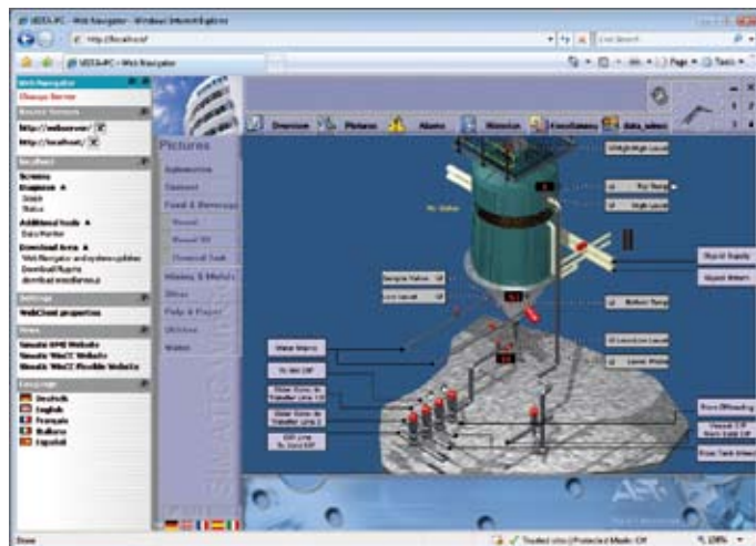
Webブラウザによる、プラントの操作およびモニタリング
