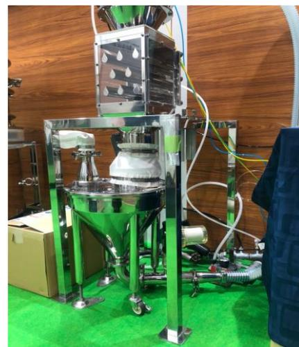
**落下式金属検出機**は、製造工程中のシュート等に設置する金属異物除去装置です。
