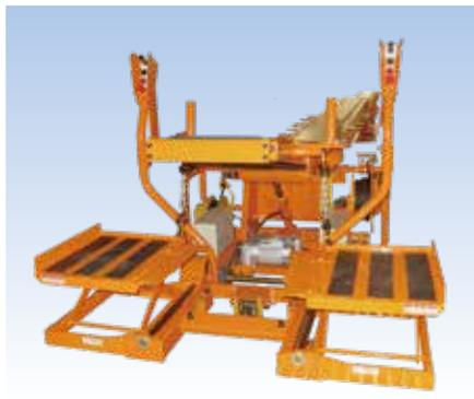
デバンダ(荷降ろし)は、昇降式作業台(シザーリフト)と伸縮ベルトコンベヤを組合せた荷役合理化装置です
