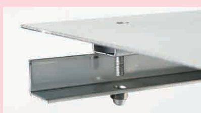
①固定側受枠のナット部に六角穴付ボルトを嵌合させます。
