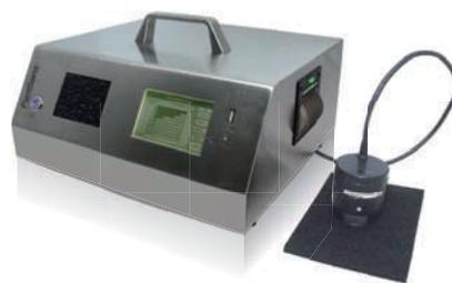
作業現場での堆積粒子や表面付着粒子を、センサを当てるだけでわずか5秒で5μm~の粒径と数をカウントします。オプションのフレキシブルパットで異物を転写することで、装置・床・ツールなどのあらゆる表面清浄度を測定できます。清掃頻度や製造時期の判断として数字で管理でき、また清掃の前後に測定することで清掃の妥当性評価として最適です。データはプリンターでの印刷かUSBで保存ができます。
