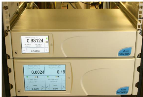
画像 1 : PACE 5000(上) / PACE 6000 (下) モジュール式圧力コントローラー
