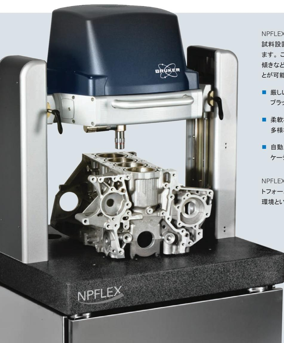
NPFLEX は、非接触型のテクニック、オープンアクセス式の試料設置、直観的な分析ソフトウェアといった特長を備えています。これにより、テクスチャー、仕上げ加工、粗さ、湾曲、傾きなど、数多くの形状をミクロン以下の分解能で分析することが可能です。
