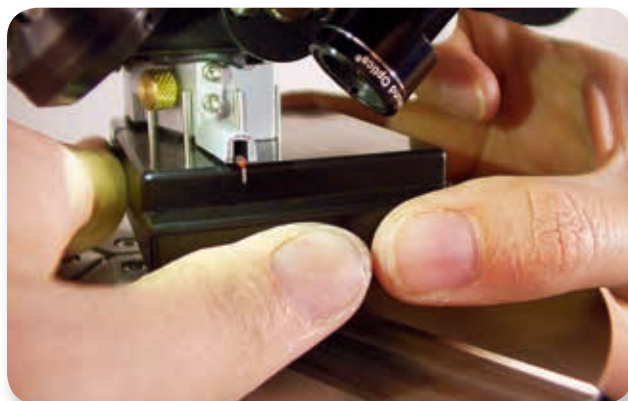
DektakXTは容易にスタイラス交換が可能な機構を備え、各アプリケーションに適したスタイラスへの変更への負荷が最小限になります。
