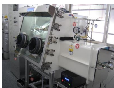
グローブボックス内で解体
