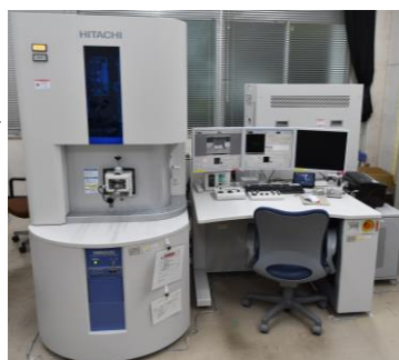
FIBによる試料作製
