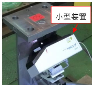
X線回折による残留応力測定状況
