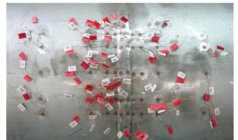
ひずみゲージによる測定状況
