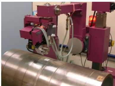
X線回折による残留応力測定状況
