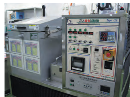
ガス腐食試験機 型式GS-UV 槽内 250mmH×380mmW×380mmD (約36L)
