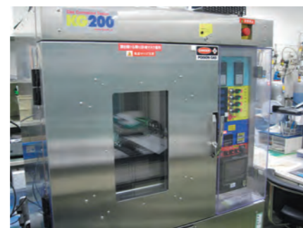
ガス腐食試験機 型式KG200ST 槽内 400mmH×400mmW×500mmD (約80L)
